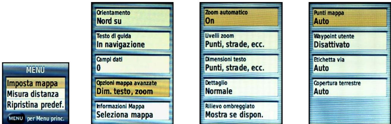
Scegliendo come "Orientamento" traccia in alto la mappa si orienta al Nord magnetico, scegliendo Nord su la mappa apparirà con il Nord verso l'alto dello strumento.
